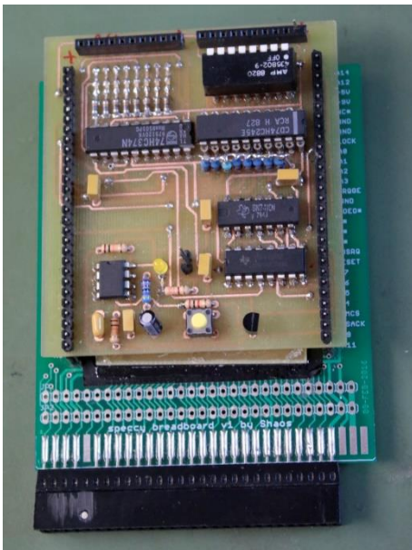
Billig-PIO aufgesteckt auf das Breadboard
